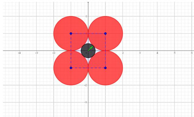
FIGURE 7 – Schéma du problème du cochonnet en dimension 2 dans un repère cartésien
